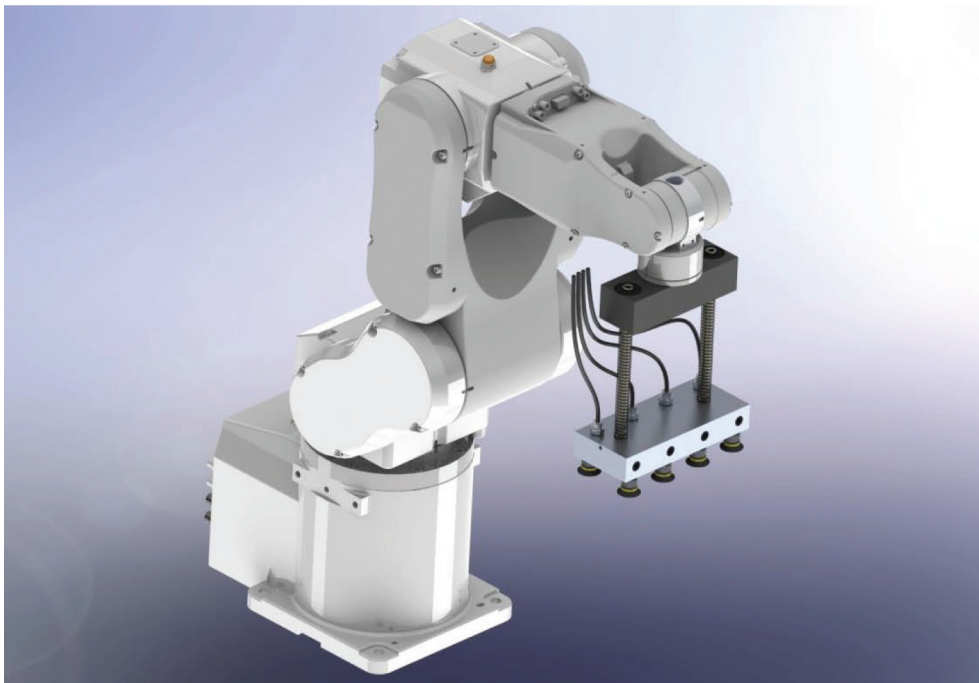
Herramienta de fin de brazo de Vaccon (VEOAT) rediseñada conectada a un robot. Las bombas de vacío Venturi controladas con válvulas de solenoide pueden realizar ciclos hasta 2.700 veces por minuto..
